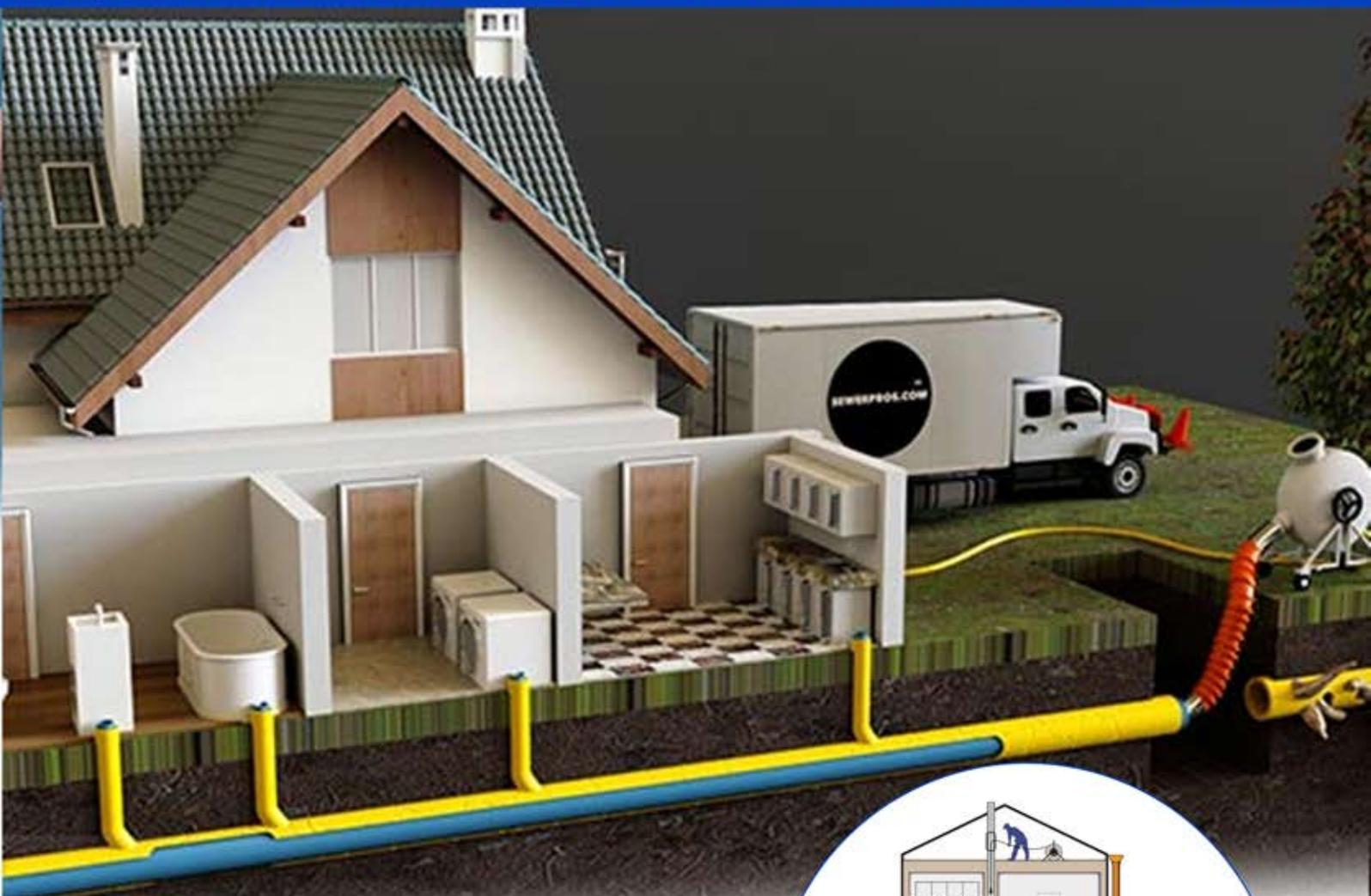
**> E' una nuova tecnologia per riparare i sistemi di tubazione non pressurizzati utilizzando punti di accesso esistenti senza demolizioni.**
